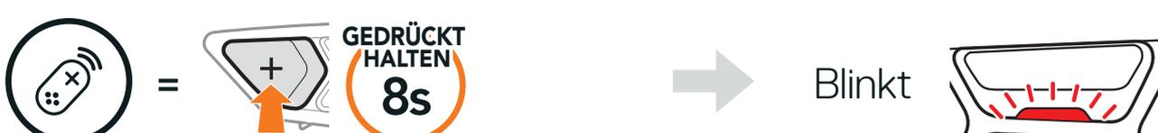
3. Das **SC2** wird automatisch mit der im Kopplungsmodus befindlichen **SC2 Fernbedienung** gekoppelt.
