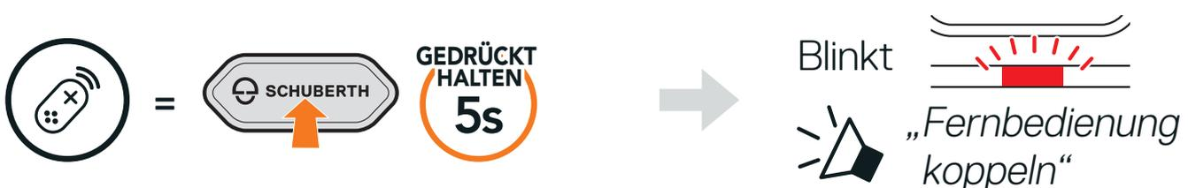
2. Halten Sie an der **SC2 Fernbedienung** die **Taste (+)** für **8 Sekunden** gedrückt, um den Bluetooth-Kopplungsmodus zu aktivieren.
